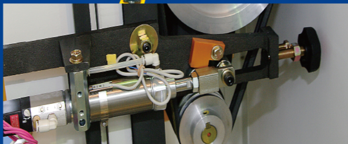
丸鋸突出し寸法調整
